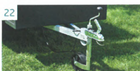
ROUE JOCKEY | Permet de manœuvrer facilement pour mettre la Camp-let en place.
