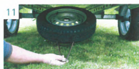
ROUE DE SECOURS 13" AVEC SUPPORT | Montage pratique sous la remorque.
